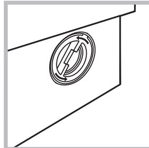
2. odšroubuje víko jeho otáčením proti směru hodinových ručiček (viz obrázek): výtečení malého množství vody je zcela běžným jevem;
